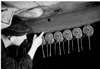
Abb. 5 Betätigung der Schließknöpfe
