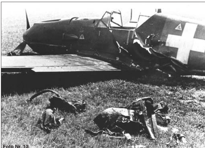
Insgesamt erhielt die Me 109 ca. 10 Treffer von vorn und unten. Dabei handelte es sich ausschließlich um Kal. 12,7 mm und um Stahlkernmunition.
