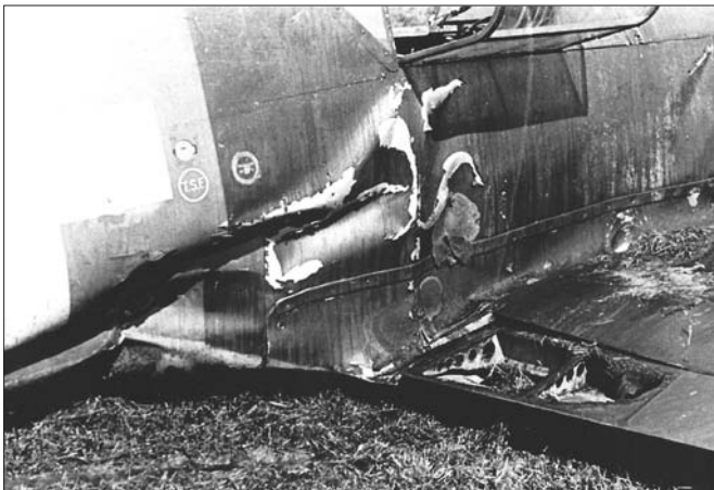
„Durch die Bauchlandung und das seitliche Durchsacken wurde das Flz. stark beschädigt (siehe Foto-Nrn. 12 und 13). Der Rumpf muss abgeschrieben werden. Die Tragflächen und Motor können repariert werden... nach Hug überführt, wo es wieder instandgestellt wird.“ Oberst Högger
