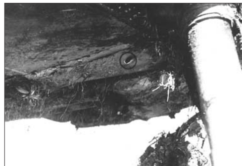
3 Geschosseinschläge durch Rumpf-Unterseite und Pilotenraum (Foto Nrn. 9 u. 10)
