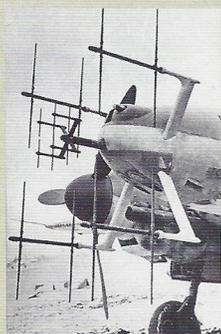
Die markant vergrößerte Antennenanlage des FuG 220 Lichtenstein SN-2 generierte höhere Seitenwindkräfte. Dies machte eine Vergrößerung der Seitenleitwerkscheiben an der Bf 110 G-4 notwendig
