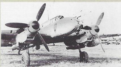
Diese mit einem FuG-202-Lichtenstein-BC-Radargerät ausgerüstete Bf 110 G-4 fand bei der Escadrila 51 Vanatoare de Noapate (51. Nachtjagdstaffel) der rumänischen Luftstreitkräften Verwendung
