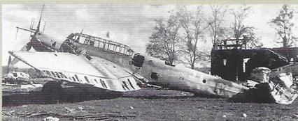
Das Kennzeichen C9+HK weist diese Bf 110 G-4 zum Nachtjagdgeschwader 5 gehörend aus. Das markante Antennengeweiß ist typisch für das FuG 220 Lichtenstein SN-2
