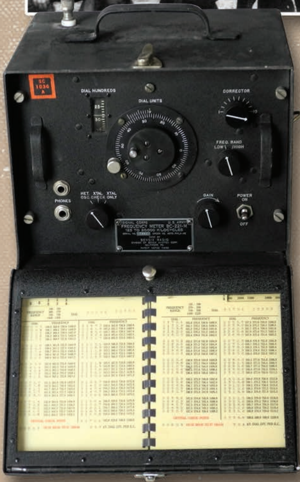
BC-221 Frequenzmesser für die Kalibrierung der B-17 Funkgeräte.
