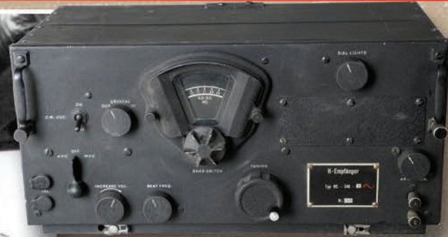
Funkempfänger in B-17 für Boden-Luft und Luft-Luft-Kommunikation.
