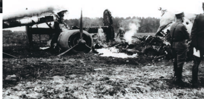
Hier sieht man die ausgebrannten Wrackteile nach dem Löschen durch die Luftschutzorganisation von Wil. Rechts der wegen Öldruckverlust stillgelegte Motor 3 - gut zu erkennen an den in Segelstellung gebrachten Propellerblättern.
