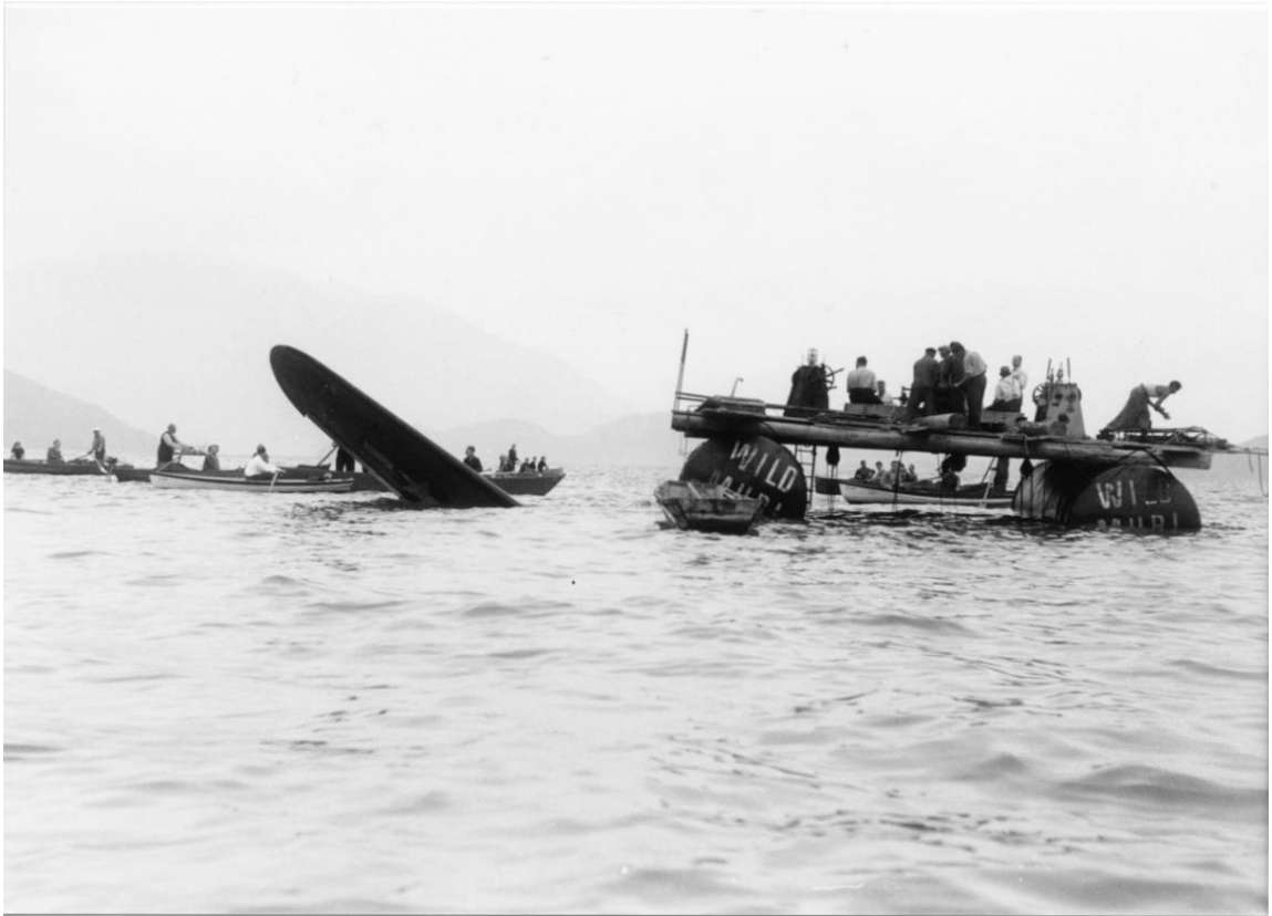
Ein Flügel des Bombers erscheint, daneben Floss mit den zwei Lagertanks à je 32'000 Liter Inhalt (Foto Eugen Grau)
