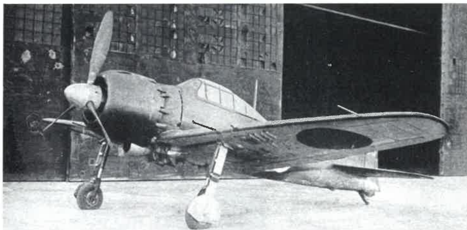
Die Oerlikon-Kanonen blieben auch bei den letzten Versionen der Zero erhalten: Die A6M7 Modell 63 mit einem stärkeren Sakae-31-Koh-Triebwerk kam ab Ende Mai 1945 zum Einsatz
